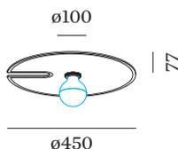
[6322E0IFO] Los datos técnicos son parámetros de referencia referidos a una temperatura ambiente de 25 °C. Los valores de flujo luminoso y de conexión eléctrica están sujetos inicialmente a una tolerancia de +/- 10 %, mientras que los valores de temperatura de color están sujetos inicialmente a una tolerancia de +/- 150 K. No asumimos ninguna responsabilidad por la presencia de erratas o errores de impresión. Se aplican las Condiciones Generales de la empresa Wever & Ducré BV.
