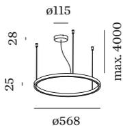
[271282B3] Los datos técnicos son parámetros de referencia referidos a una temperatura ambiente de 25 °C. Los valores de flujo luminoso y de conexión eléctrica están sujetos inicialmente a una tolerancia de +/- 10 %, mientras que los valores de temperatura de color están sujetos inicialmente a una tolerancia de +/- 150 K. No asumimos ninguna responsabilidad por la presencia de erratas o errores de impresión. Se aplican las Condiciones Generales de la empresa Wever & Ducré BV.
